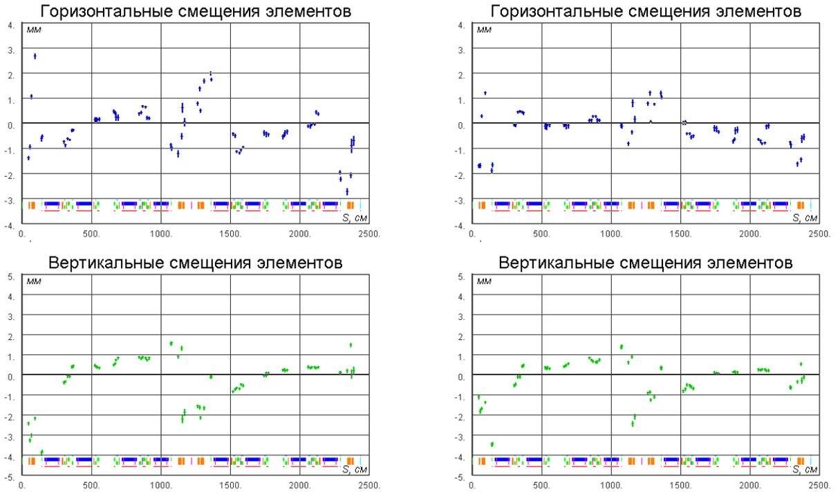
Рис. 3.16. Пример коррекции орбиты 2010-2011 гг: слева до коррекции, справа после.
