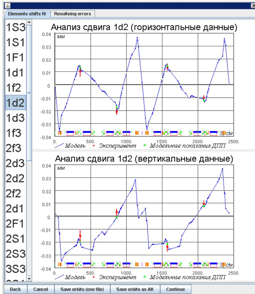
Рис. 3.12. Диалоговое окно, демонстрирующее найденные искажения орбиты и иллюстрирующее соответствие между модельными откликами от найденных искажений и экспериментальными данными
