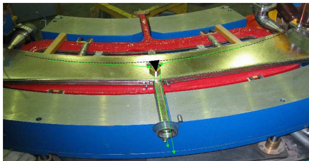
Рис. 2.6. Половина магнита с вакуумной камерой.
